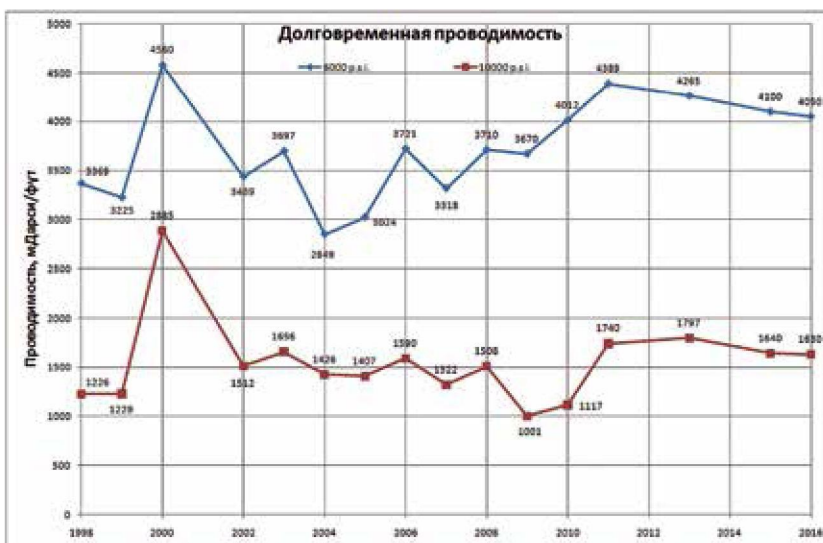
Рисунок 2 – Эволюция основных свойств пропантов BORPROP фракции 20/40 по годам выпуска
